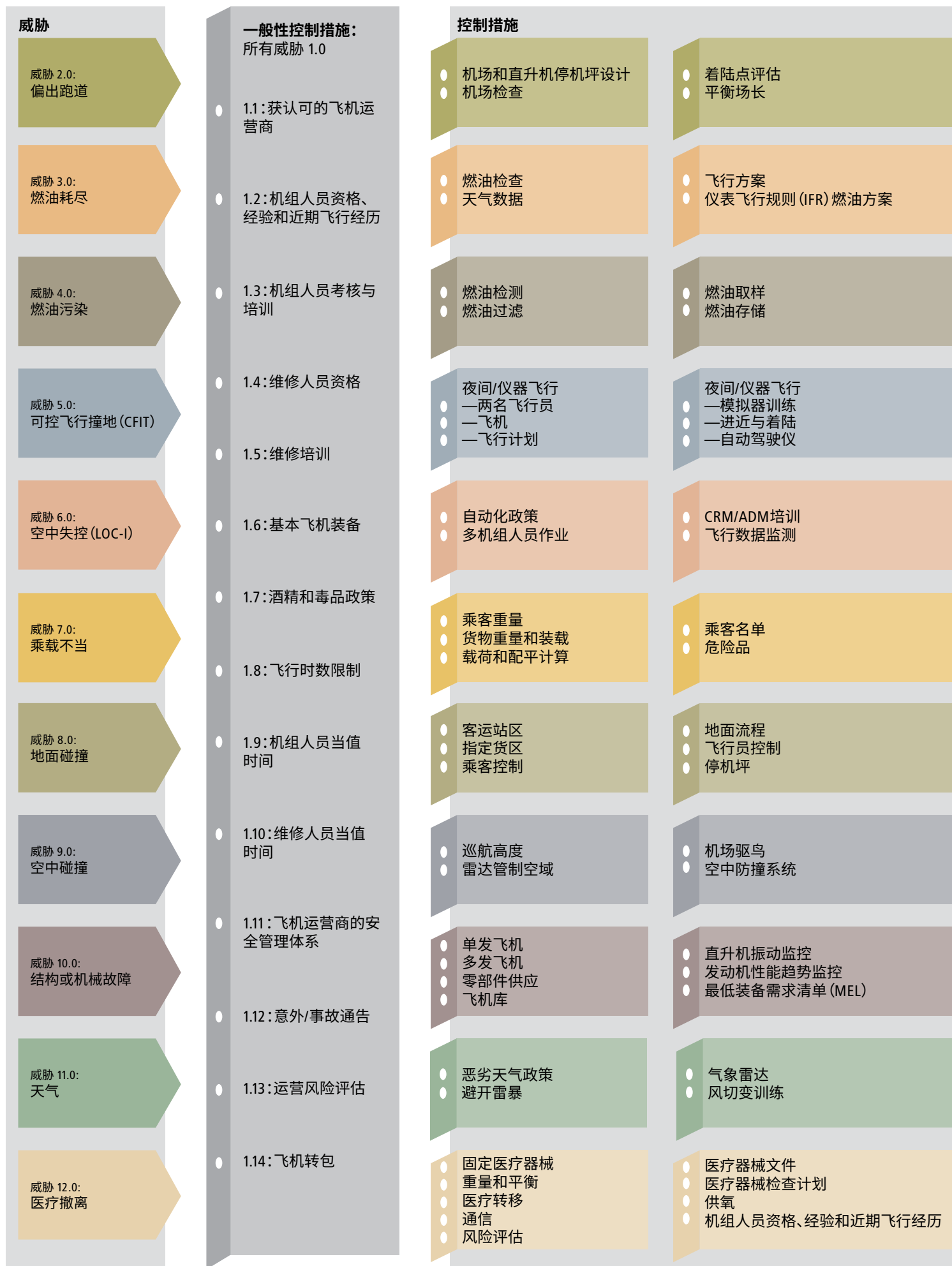
图1: BARS领结式风险分析模型 —— 航空风险管理中的控制措施及补救措施图解
